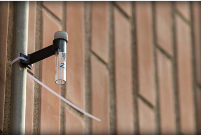
Tubo de difusión como medidor pasivo de NO 2 empleado en el proyecto xAire en Barcelona.
